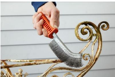
Grobe Roststellen bürsten Sie mit einer Drahtbürste ab. Der **Alpina Anti-Rost Metallschutz-Lack** hält zwar auf Rost, jedoch muss der Untergrund tragfähig sein.
